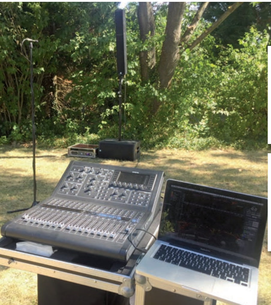
Hier sieht man das Komplettestem bestehend aus VB210 Subwoofer, VLS64 Säule und DA428 System-Endstufe (Messungen VB210 Subwoofer VLS64: K.M.E.)
