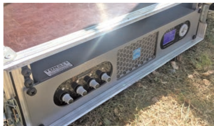
Die haus eigene System-Endstufe DA428 mit integriertem DSP
